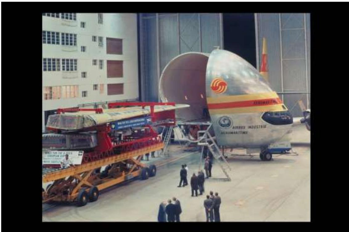
Avec un fuselage de 34 m de long, un diamètre de 7,60 m, la soute du Super
